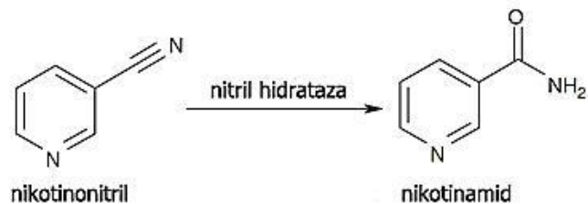
Slika 4. Hidroliza nikotinonitrila u nikotinamid pomoću imobiliziranih stanica Rhodococcus rhodochrous J1 (Ghisalba i sur., 2010)
