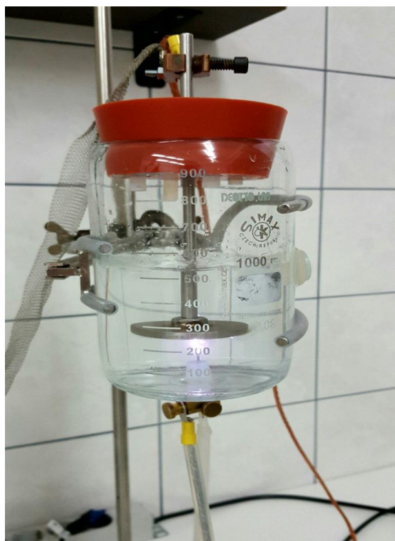
Slika 5. Reaktor s tekućinskim izvorom plazme (vlastita slika)
