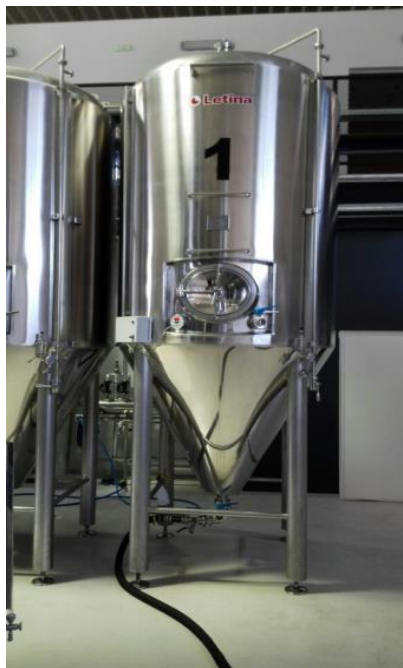
Slika 4. Cilindrično-konusni fermentor (zapremnine 4000 L), Zmajska pivovara d.o.o. (Stegnjaić, 2017)
