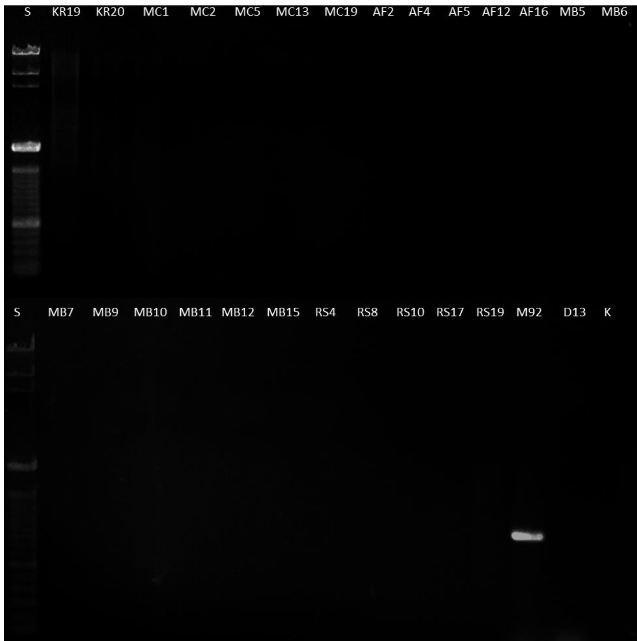
Slika 12. Elektroforeza produkata PCR reakcije sa specifičnim Us1 početnicama za gene koji kodiraju za S-proteine
