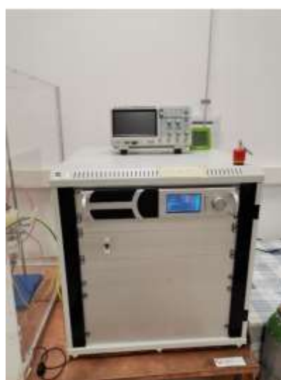
Slika 5. HVED generator (Impel grupa, Zagreb, Hrvatska)
