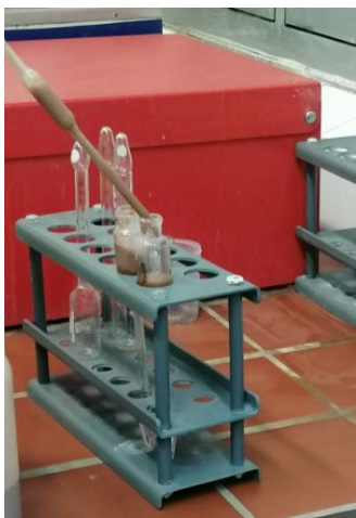
Slika 11. Pipetiranje sladoledne smjese za određivanje sadržaja masti (Ledo plus d.o.o. vlastita fotografija, 2021)
