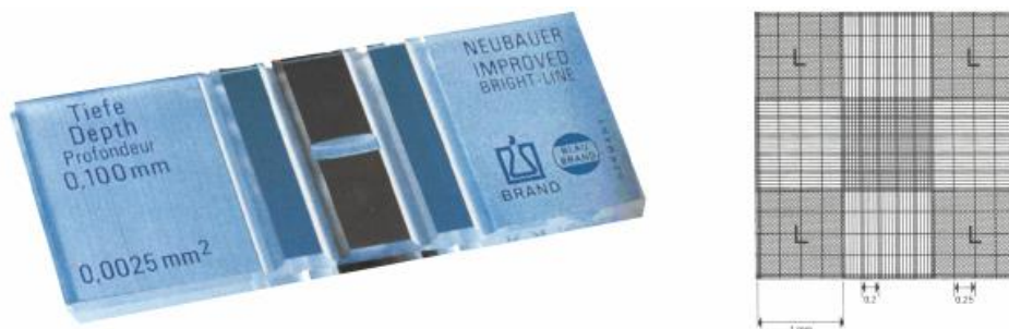
Slika 5. Prikaz Neubauerove komorice za brojanje stanica. (Anonymus 2, 2021)
