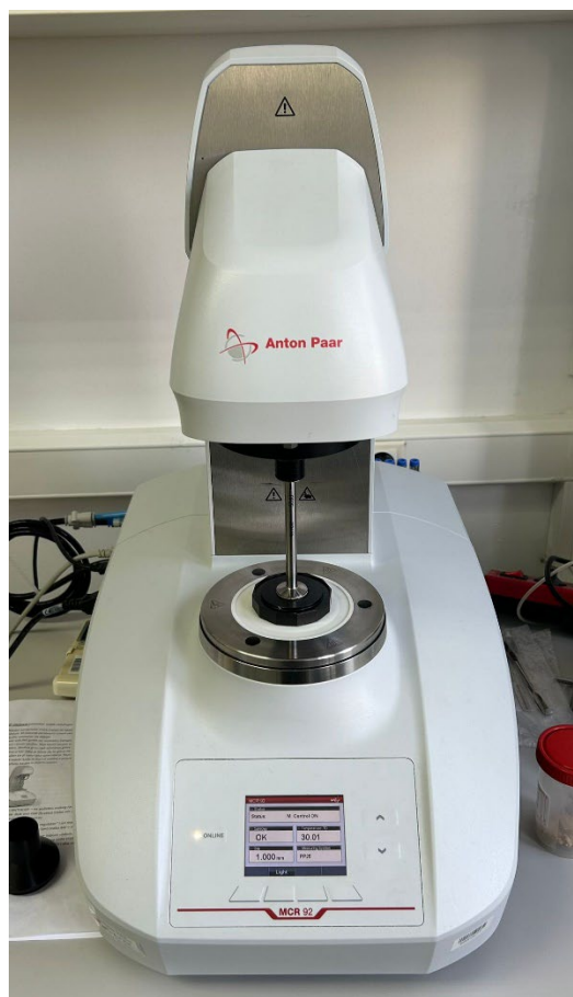
Slika 7. Oscilacijski reometar (vlastita fotografija)
