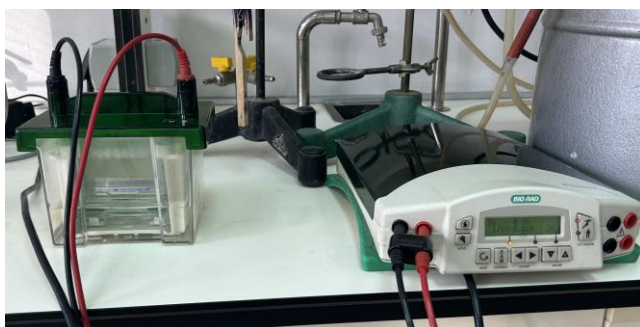
Slika 3. Prikaz aparature za provođenje SDS-PAGE, vlastita fotografija
