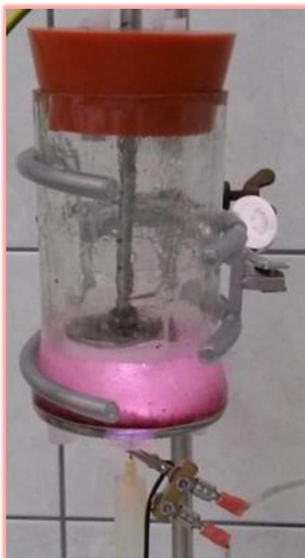
Slika 8. Reaktor ekstraktora tijekom postupka ekstrakcije hladnom plazmom
