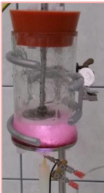
Slika 8. Reaktor ekstraktora tijekom postupka ekstrakcije hladnom plazmom
