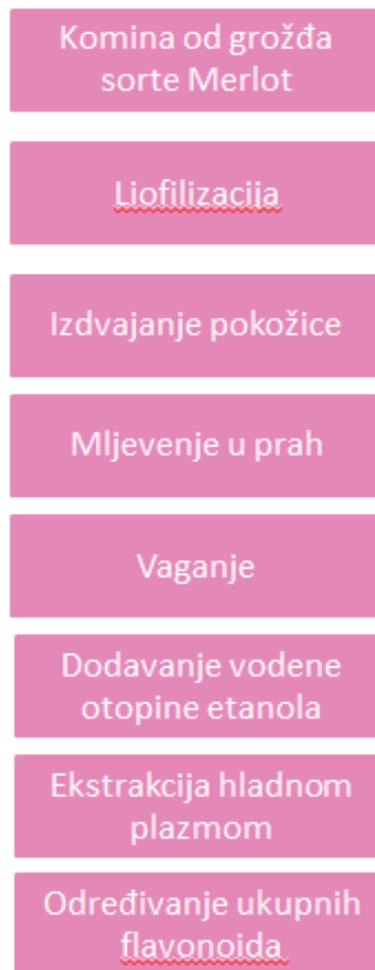
Slika 7. Shematski prikaz provedbe istraživanja
