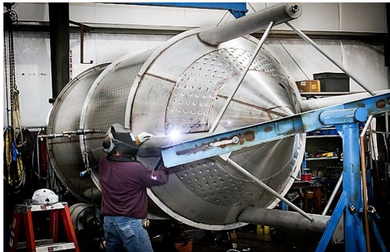
Slika 25. Popravak nehrđajućeg spremnika hrane za stoku
