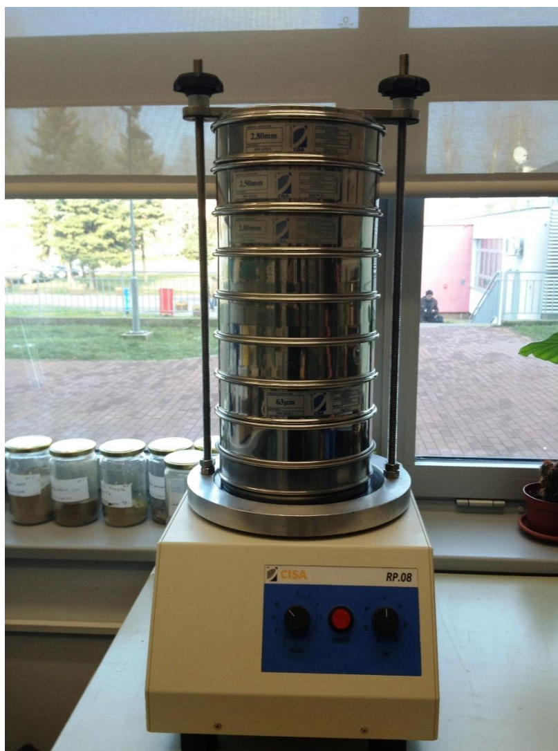
Slika 8. Elektromagnetska tresilica za prosijavanje CISA RP08 \varnothing 200/203
