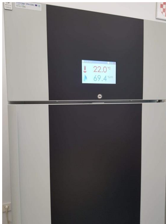
Slika 4. Termostat komora (Izvor : Petrić, 2019.)
