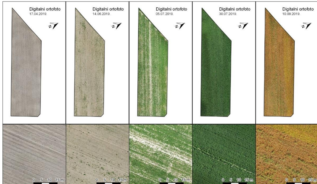
Slika 9. Digitalni ortofoto kroz 5 faza cikličkog snimanja bespilotnim zrakoplovom
