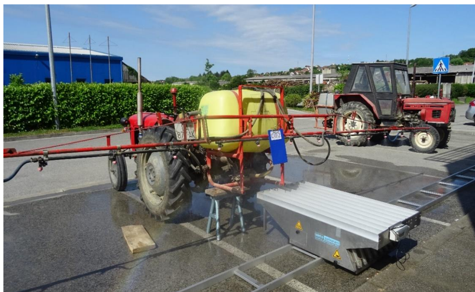
Slika 1. Provjera ispravnosti rada ratarske prskalice u gradu Kutjevo
