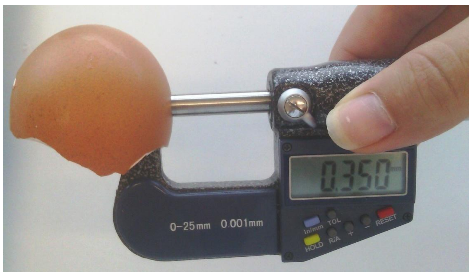
Slika 14. Mjerenje debljine ljuske pomoću elektroničkog mikrometra
