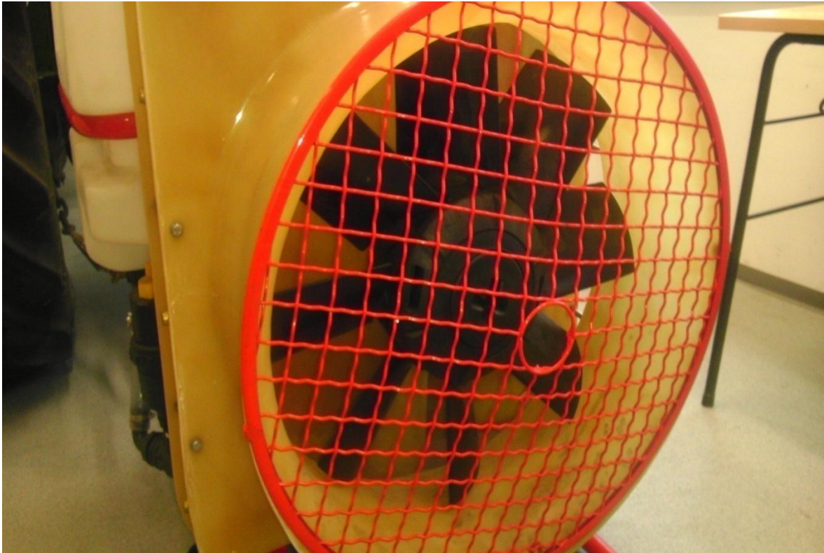
Slika 2. Aksijalni ventilator raspršivača Agromehanika
