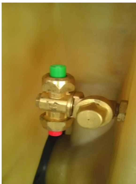
Slika 7. Nosači za mlaznice na raspršivaču Agromehanika 400EN
