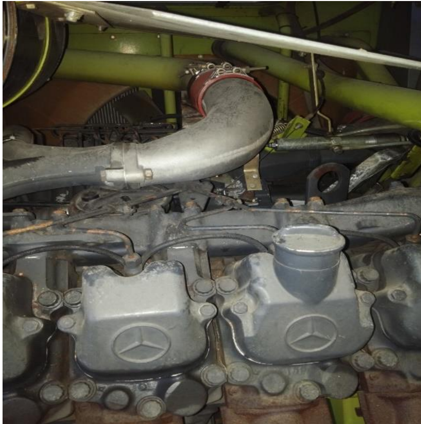
Slika 8. MercedesBenzov motor snage 268 kW (Izvor : Kolak, I.)
