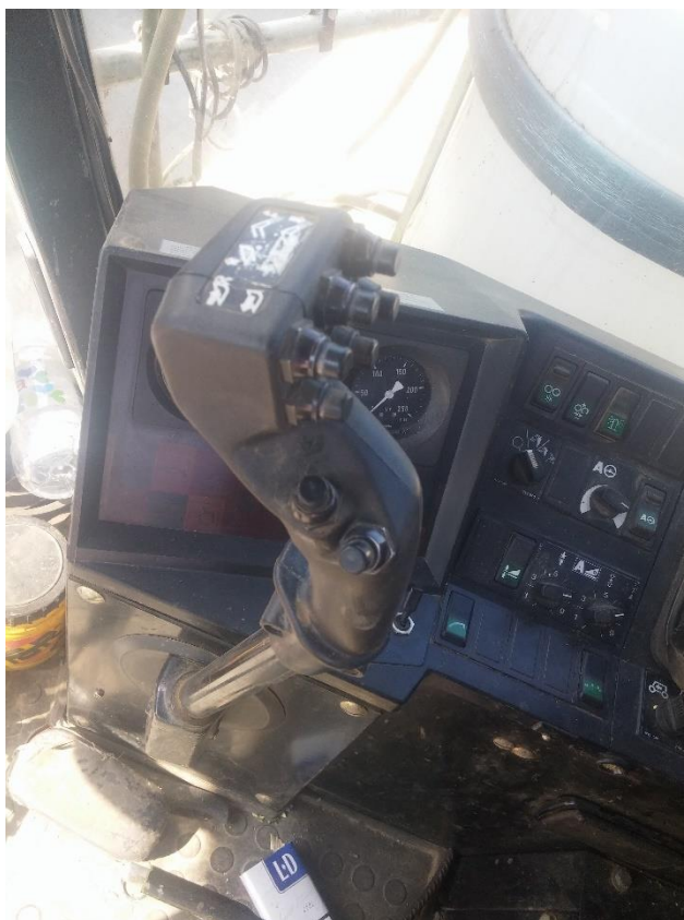
Slika 20. Ručica/varijator za upravljanje (Izvor : Kolak, I.)
