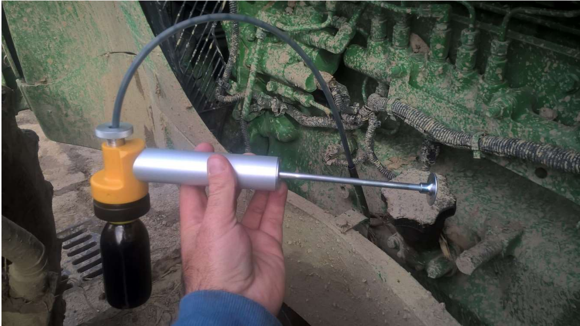
Slika 7. Crpka za izuzimanje uzoraka ulja, vlastita fotografija
