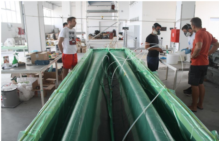
Slika 10 - Primjer gradnje plovila vakuumskom infuzijom u kalupu
