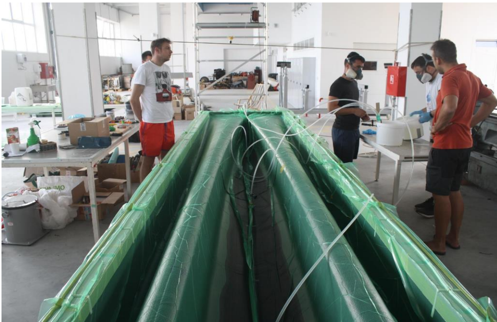
Slika 10 - Primjer gradnje plovila vakuumskom infuzijom u kalupu
