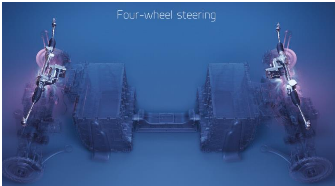
Slika 14. Izvedba kojom je omogućeno okretanje svih kotača na Zoox autonomnom vozilu
