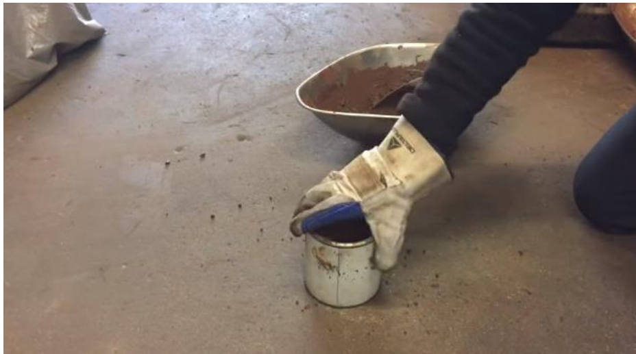
Slika 25: CAN TEST – brzi test za provjeru stanja vlage u teretu
