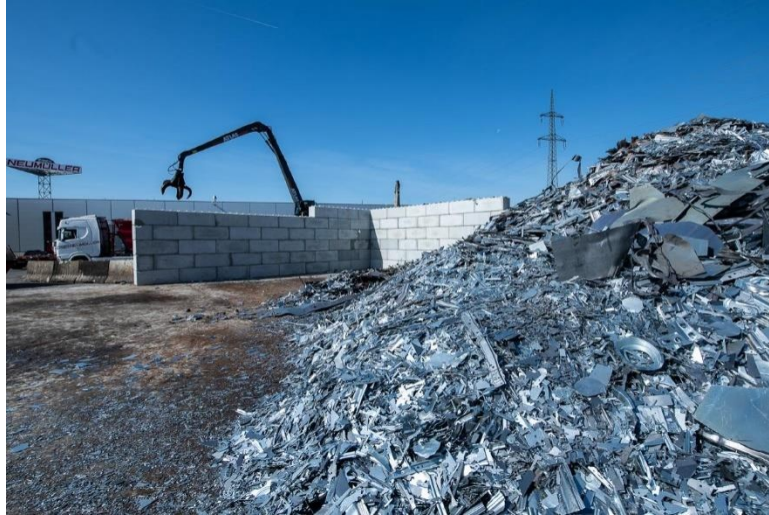
Slika 4. Primjer željeznog otpada E8 kvalitete
