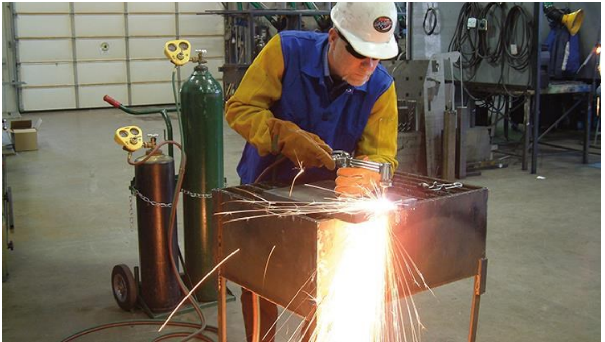
Slika 10. Postupak plinskog ili autogenog rezanja
