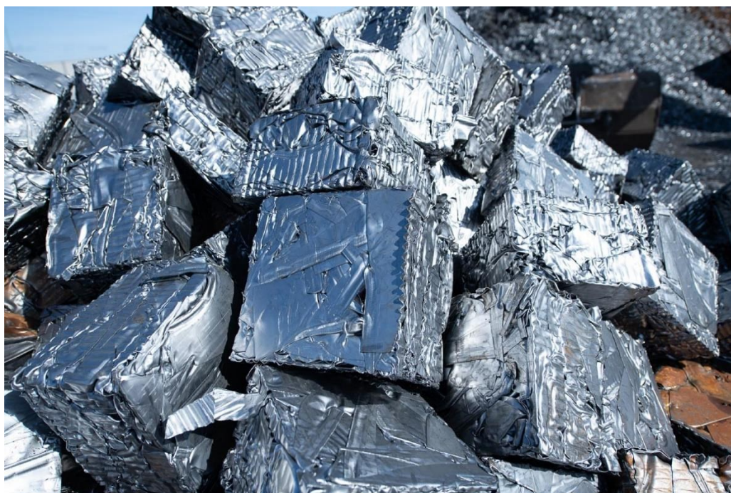
Slika 5. Primjer željeznog otpada kvalitete E6 stlačenog u kocke
