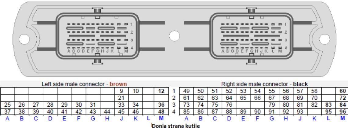
Slika 41. Priključci i pinovi na ID-Mobile Logger-u [9]
