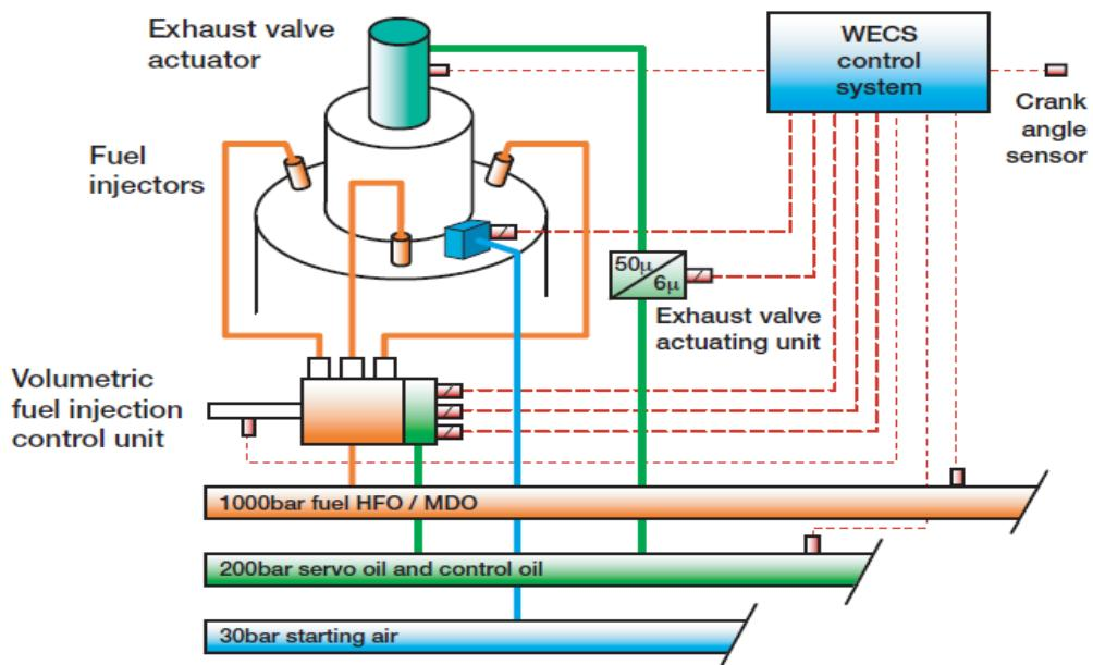
Slika 11. Shematski prikaz koncepta RT-flex motora [12]
