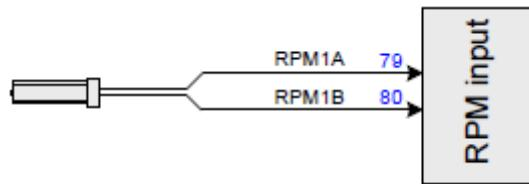
Slika 49. Ulaz za mjerjenje broja okretaja motora (RPM), koristi magnetsko očitavanje [9]
