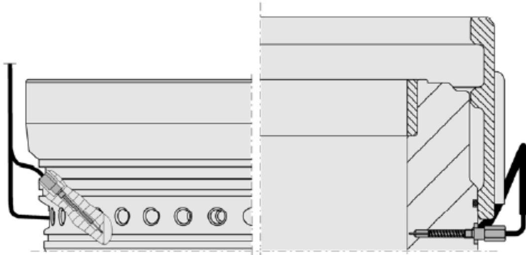
**Slika 19. Mjerjenje temperature košuljice cilindra s termoparom [14]**
