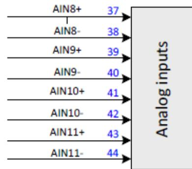
Slika 46. Analogni ulazi konfigurabilni za upotrebu strujnih, otpornih, naponskih i termopar senzora [9]
