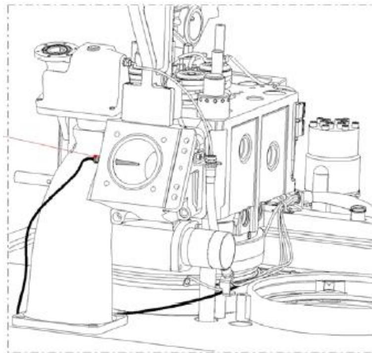
**Slika 20. Mjerjenje temperature ispušnih plinova [14]**
