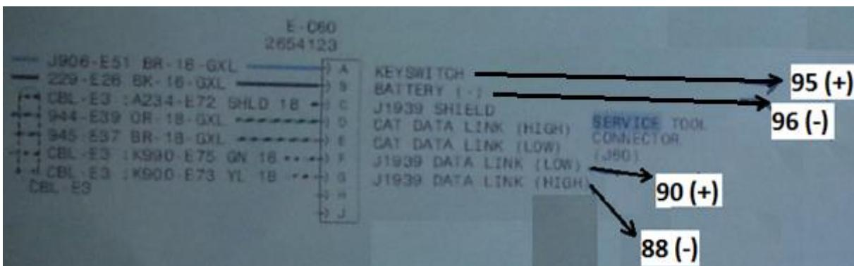
**Slika 64. Shema spajanja ID-Mobile Loggera na motor**
