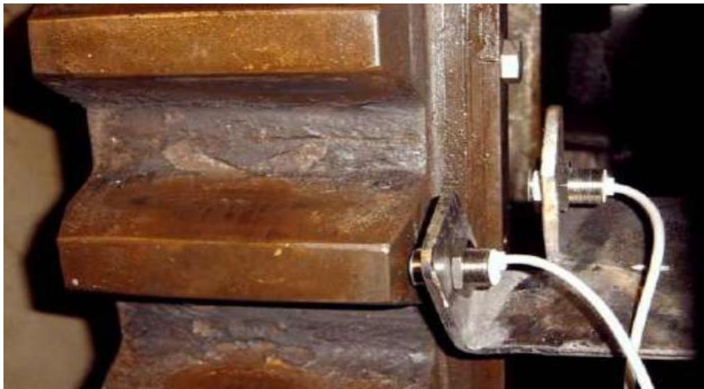
**Slika 25. Induktivni pick-up davač brzine vrtnje u načinu rada sa mjeranjem položaja gornje mrtve točke i mjerjenje položaja zubaca zamašnjaka [11]**
