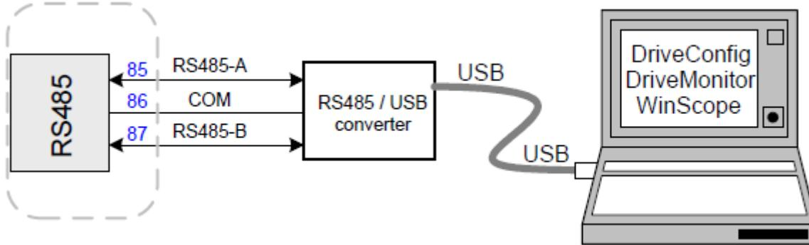
**Slika 51. Shema spoja RS485 na računalo [9]**
