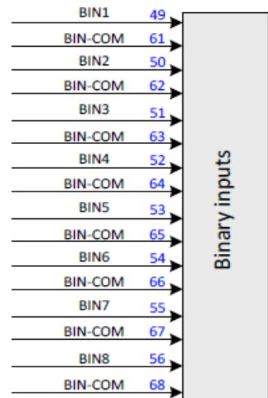
Slika 47. Aktivacija na minus napajanja, nivo prebacivanja: aktivno  $\leq 2$  V DC, brzina uzorkovanja: 100 ms [9]
