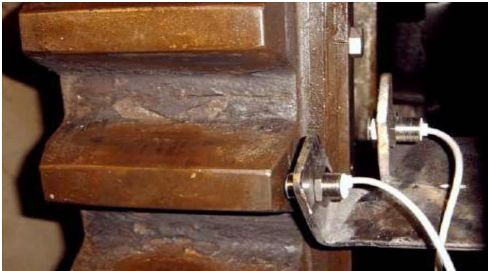
Slika 25. Induktivni pick-up davač brzine vrtnje u načinu rada sa mjerenjem položaja gornje mrtve točke i mjerenje položaja zubaca zamašnjaka [11]
