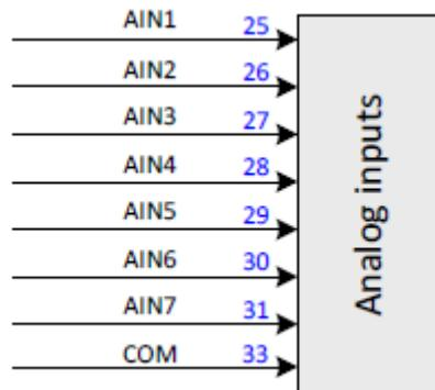
Slika 45. Analogni ulazi podešivi za upotrebu strujnih, otpornih i naponskih senzora [9]
