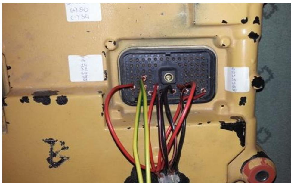
Slika 53. Izvođenje pinova sa ECU-a
