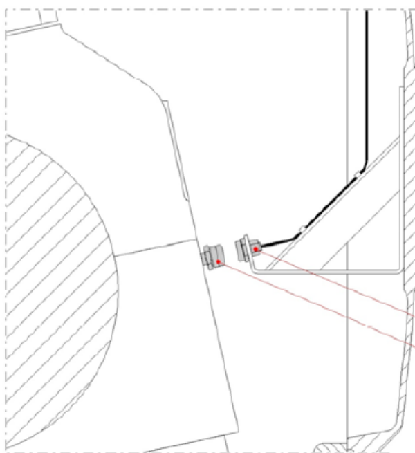
Slika 32. Instalacija bežičnog senzora [14]
