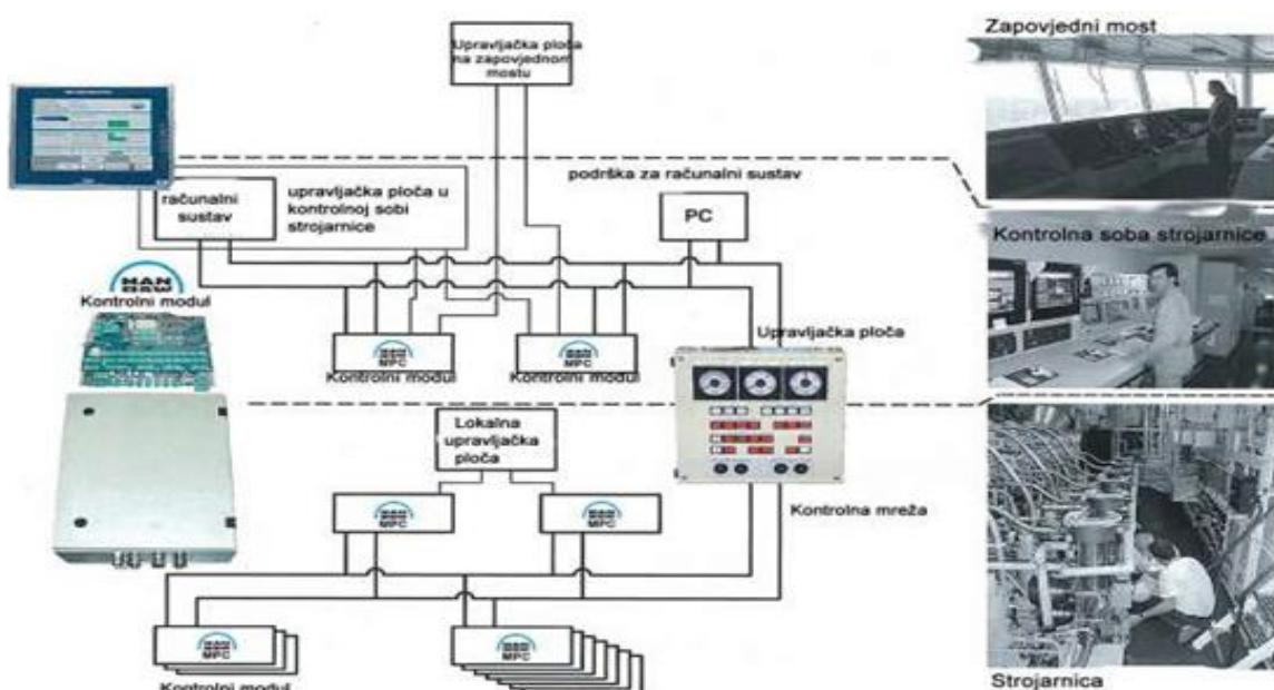
Slika 7. Shematski prikaz upravljačkog sustava ME-C motora [10]
