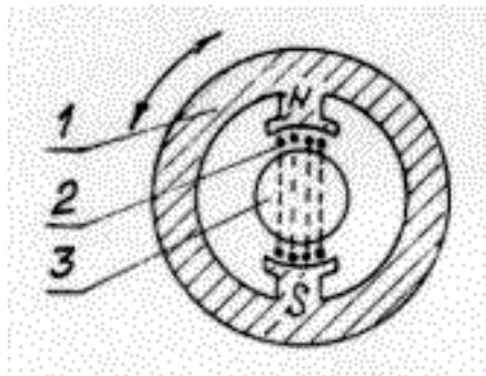
Slika 27. Skica induktivnog davača električnog torziografa [7]
