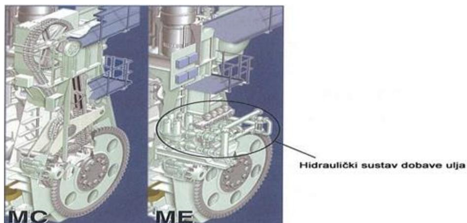
Slika 5. Razlika u mehaničkim sastavicama MC-C i ME-C motora [13]
