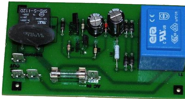
Slika 4.1 Jednoslojna tiskana pločica
