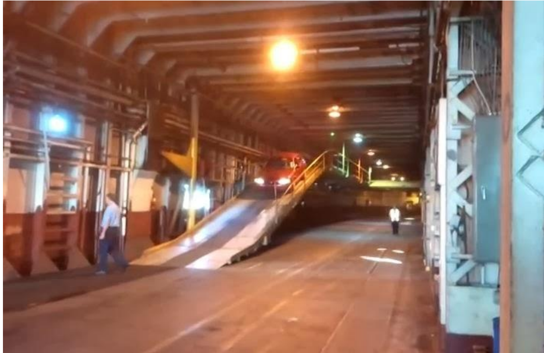
Slika 7. Prostor za teret kod RO-RO brodova [6]
