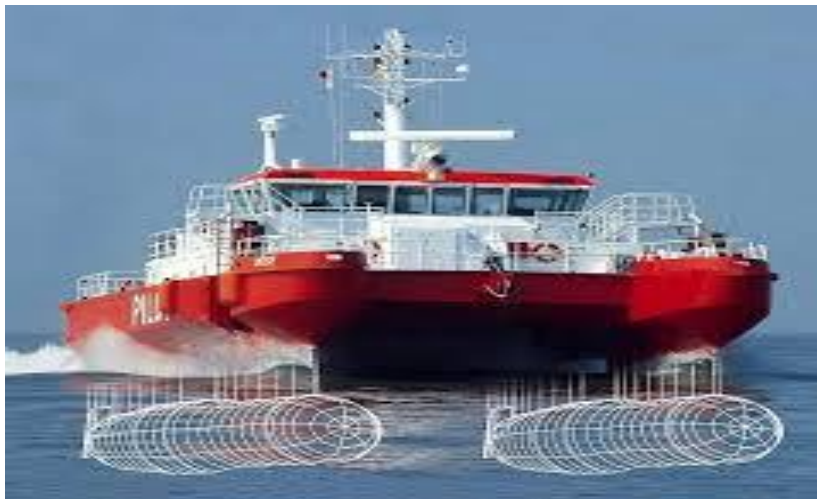
Slika 8. Brod sa malom površinom vodene linije [preuzeto sa www.bluebird-electric.net ]
