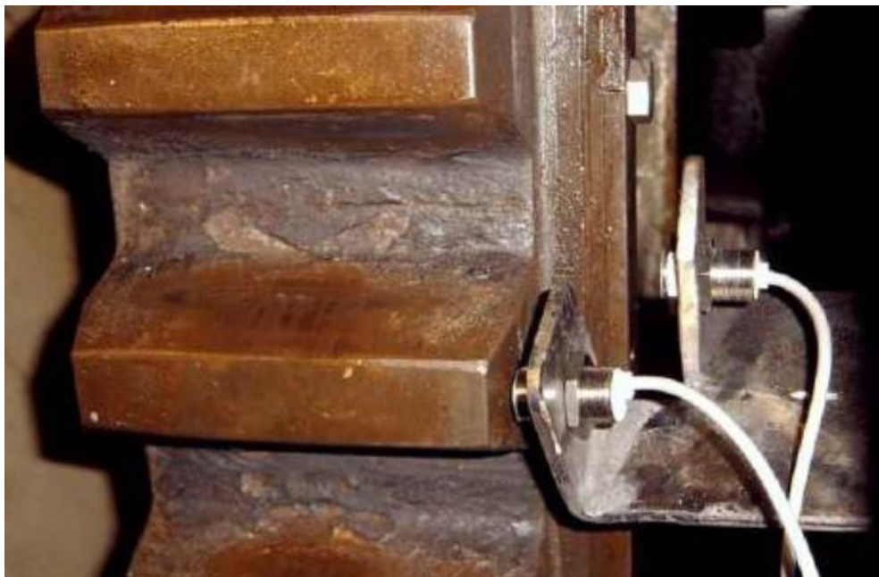
Slika 14. Induktivni davač brzine vrtnje [4]
