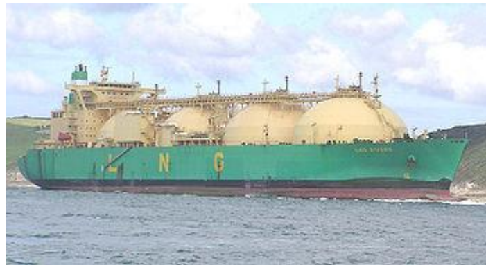
Slika 8. LNG brod sa samonosivim spremnicima [18]
