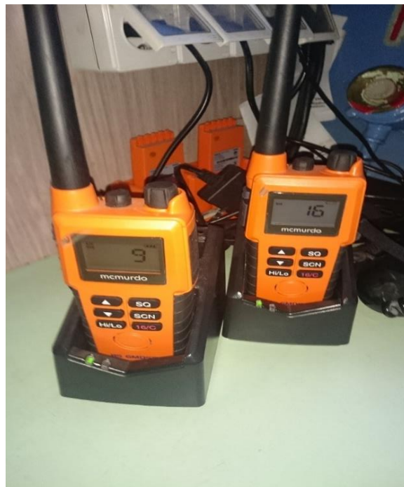
Slika 16. McMurdo R5 prijenosna VHF stanica
