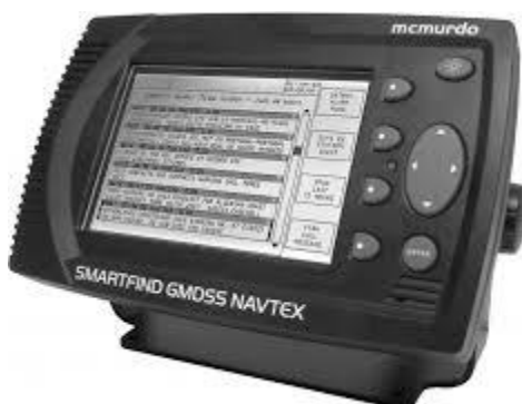
Slika 10. McMurdo Smartfind GMDSS [5]
