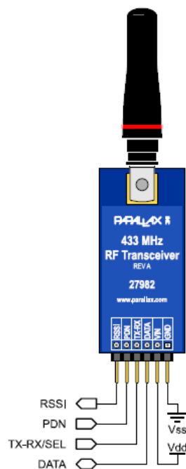
Slika 10. 433 MHz RF antena - konfiguracija nožica [1]
