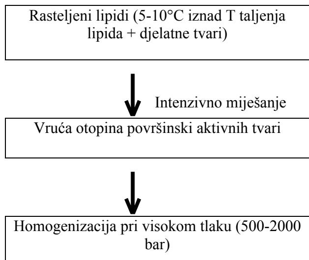
Slika 11. Shematski prikaz pripreme SLN metodom vruće homogenizacije
