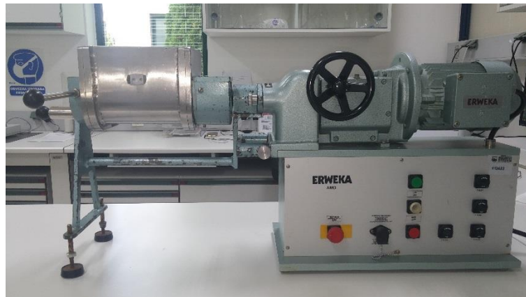
Slika 1.(a) Pogonska jedinica AMD (Erweka) s nastavkom za vlažnu granulaciju
