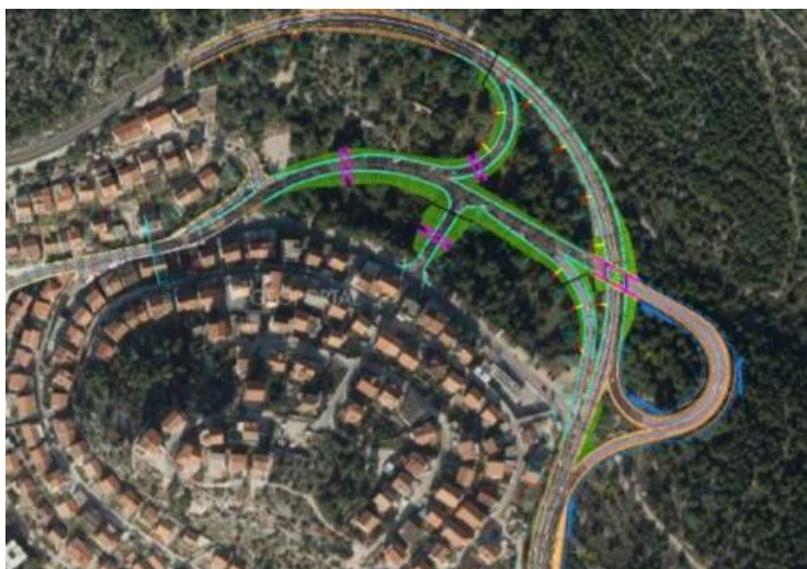
Sl.8. Skica Čvora Rokići nakon rekonstrukcije Izvor: Hrvatske ceste (2017)
