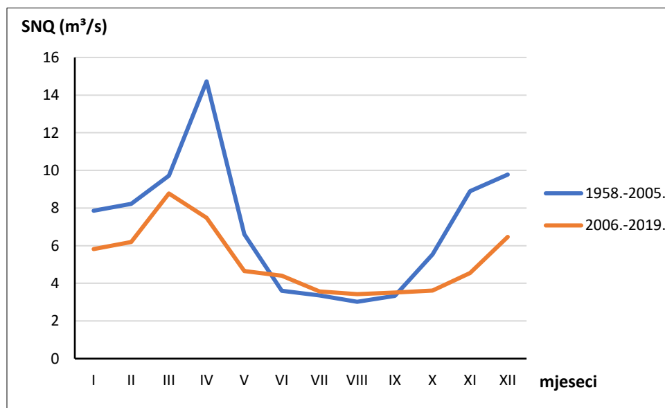
Sl.16. Usporedba prosječnih mjesečnih vrijednosti minimalnih protoka na postaji Stative Donje u razdoblju 1958.-2005. i 2006.-2019.
