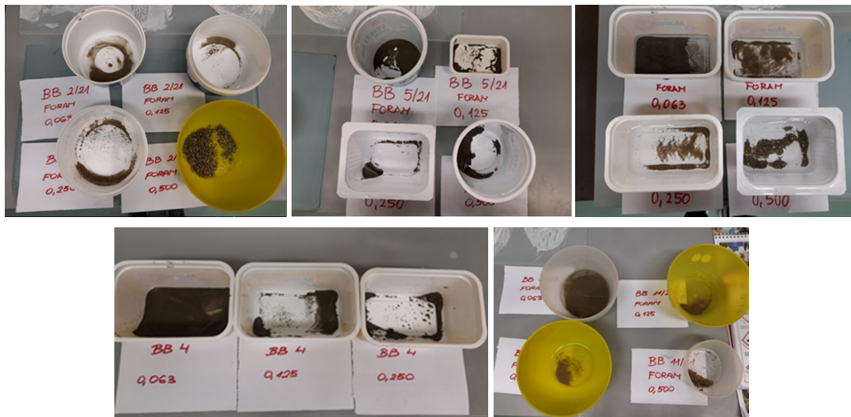
Slika 12. Uzorci sa svojim frakcijama ostavljeni na sušenju
