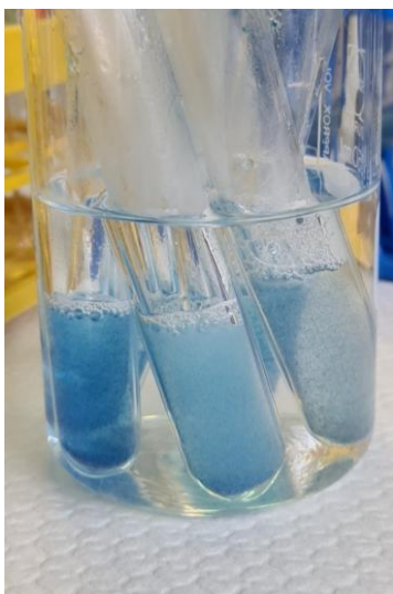
Slika M3. Prikaz razgradnje škroba amilazom na koji su vezane granule plave boje.
