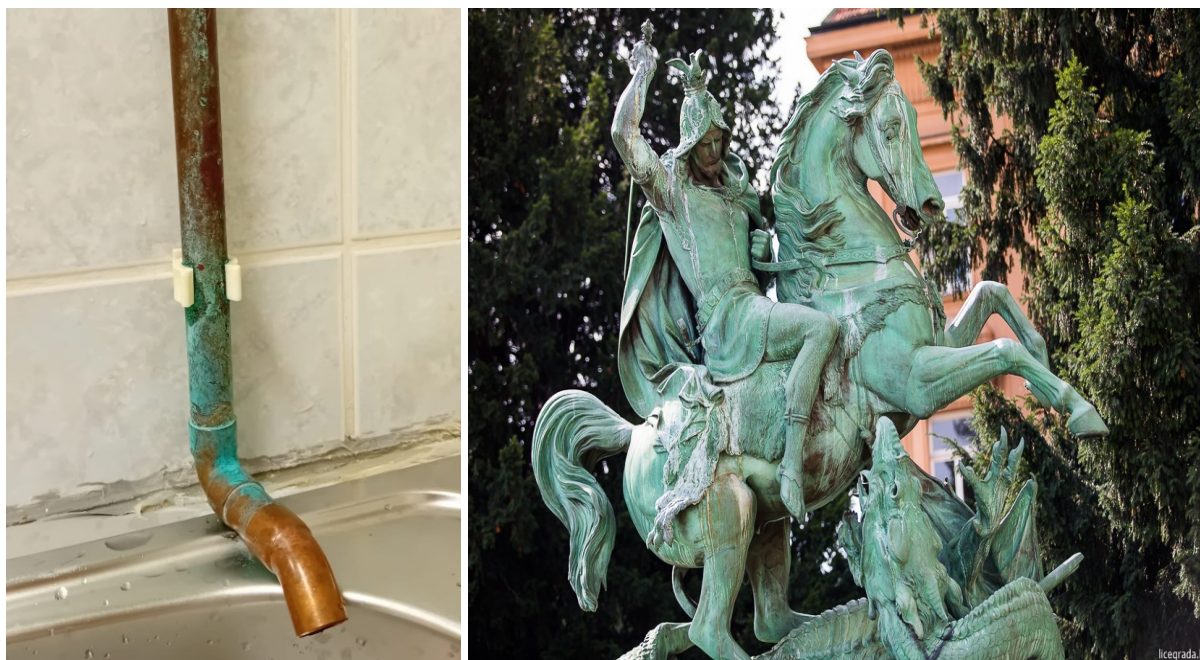
Slika M1. Prikaz bakrene cijevi u vlažnim uvjetima obložene slojevima patine (lijevo). Kip sv. Jurja obloženog patinom ispred zgrade HNK u Zagrebu 62 (desno).
