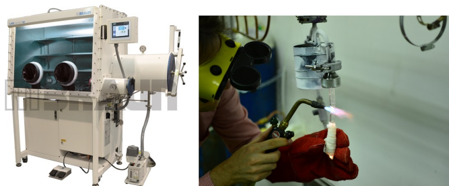
Slika 5.1: (lijevo) Glovebox komora korištena za miješanje elemenata za sintezu. (desno) Zatvaranje druge strane ampule nakon ispumpavanja.
