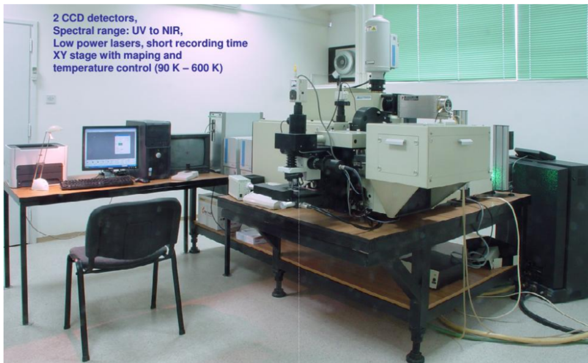
Slika 4.7: Ramanov spektrometar Horiba - Jobin Yvon T64000 koji se nalazi u Laboratoriju za molekulska fiziku i sinteze novih materijala, Instituta Ruđer Bošković.
