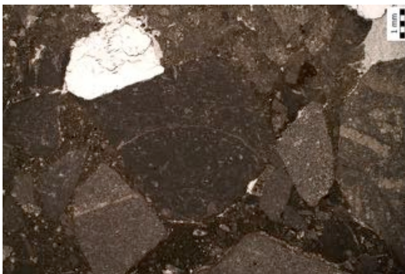
Slika 36) Mikrobreča sa zrnima biomikrita. Uzorak/točka 1222.
