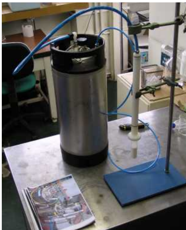
Slika 7. Sustav za ekstrahiranje velikih volumena vode u Laboratoriju za molekularnu ekotoksikologiju Instituta „Ruđer Bošković“.
