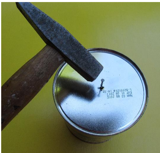
Slika 5.13. Bušenje rupice zabijanjem čavla.
