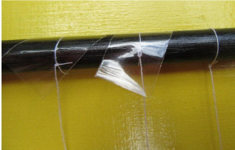
Slika 5.4. Usklađivanje duljine konca ljepljivom trakom.
