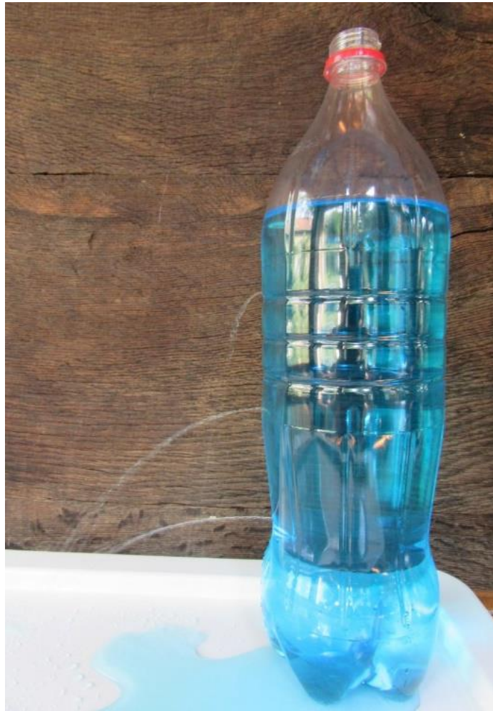
Slika 4.2. Plastična boca s 3 rupice na različitim visinama.
