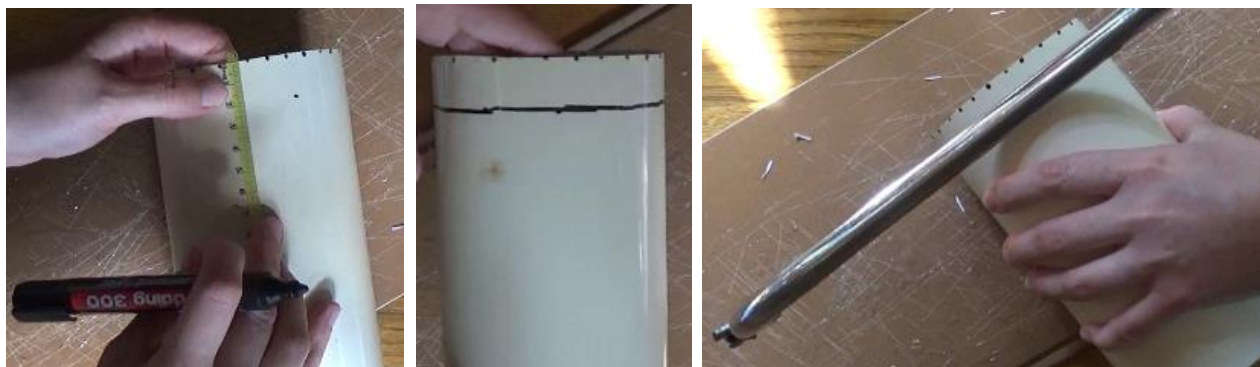
Slika 2.9. Označavanje i piljenje cijevi.
