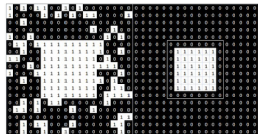
(a) Binarna slika prije i poslije primjene dilatacije (b) Binarna slika prije i poslije primjene erozije
