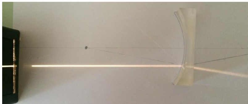
Slika 2.22: Zraka paralelna optičkoj osi lomi se tako da izgleda kao da izlazi iz fokusa bliže izvoru svjetlosti
