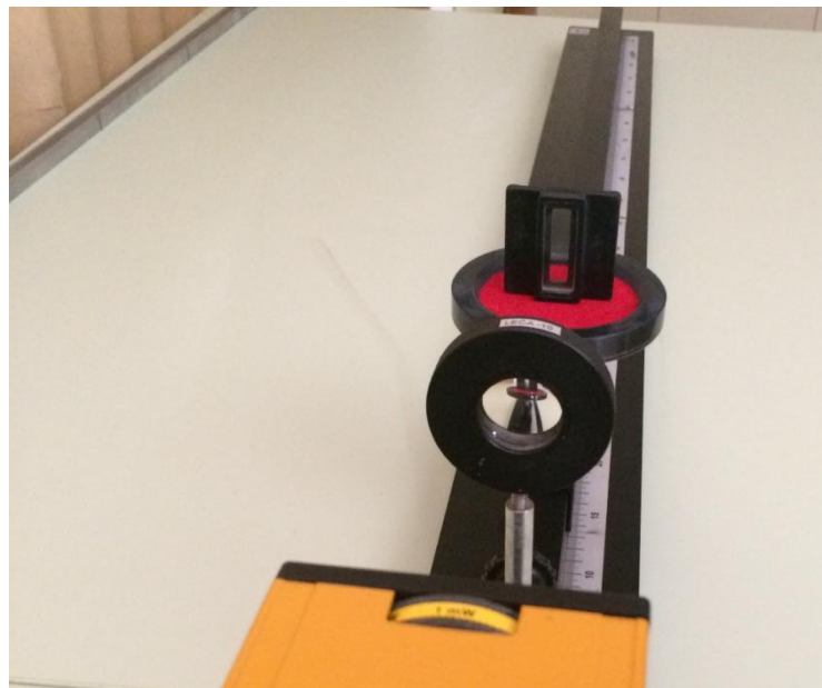
Slika 3.3: Laser, divergentna leća i Fresnelova biprizma
