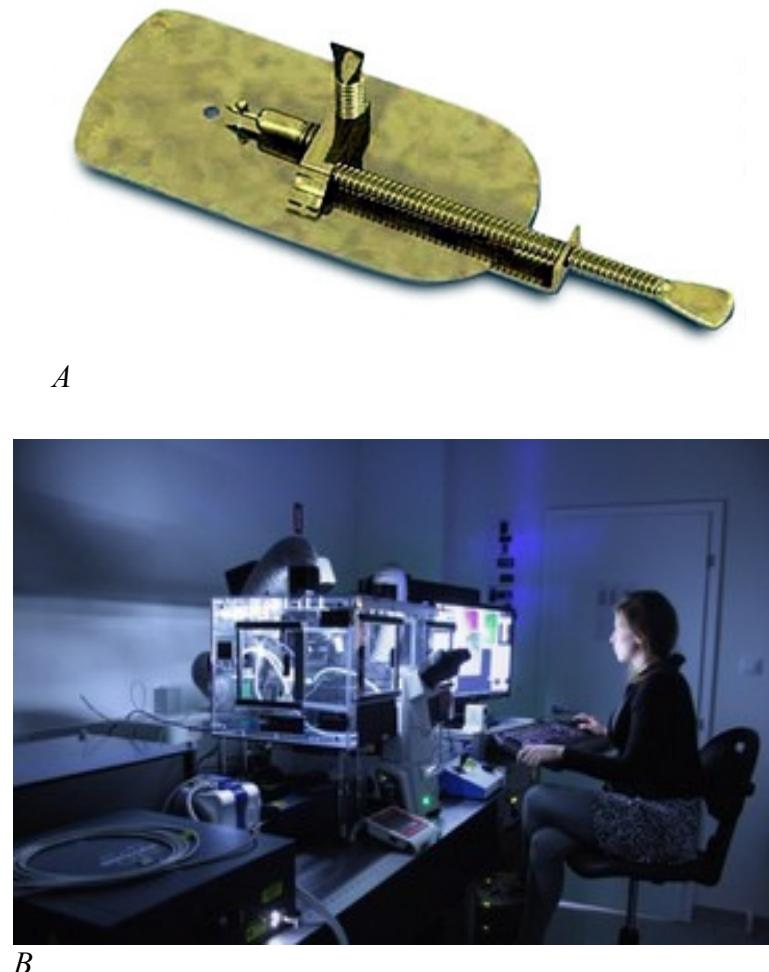
**Slika 2.** A) Model prvog mikroskopa iz 18. Stoljeća koji se sastojao od sustav leća vezanih na metalni držač koje su se fokusirale s pomoću metalnog vijka. Preuzeto iz ref. 6. B) Moderni fluorescencijski konfokalni mikroskop. Preuzeto iz ref. 7.
