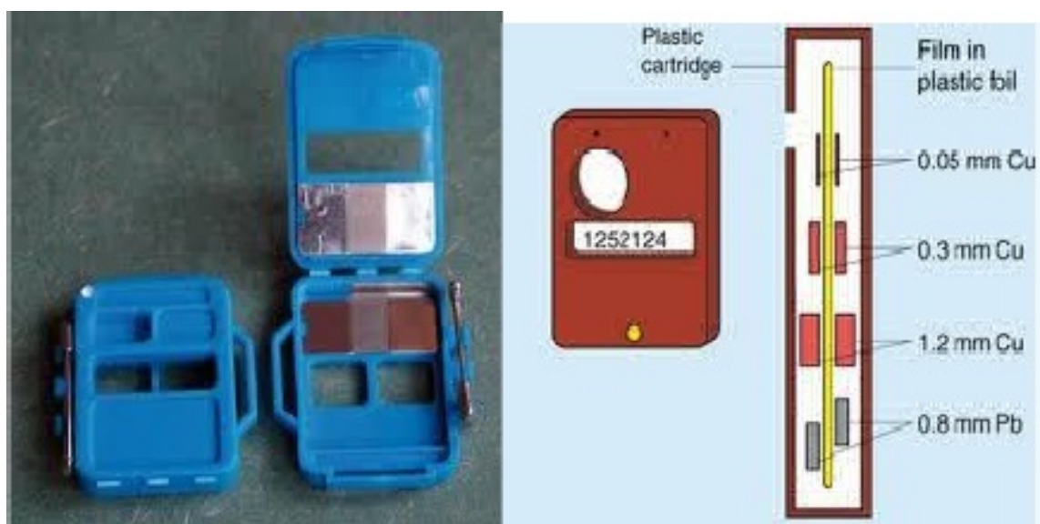
Slika 1.3: Film dozimetar. [6]
