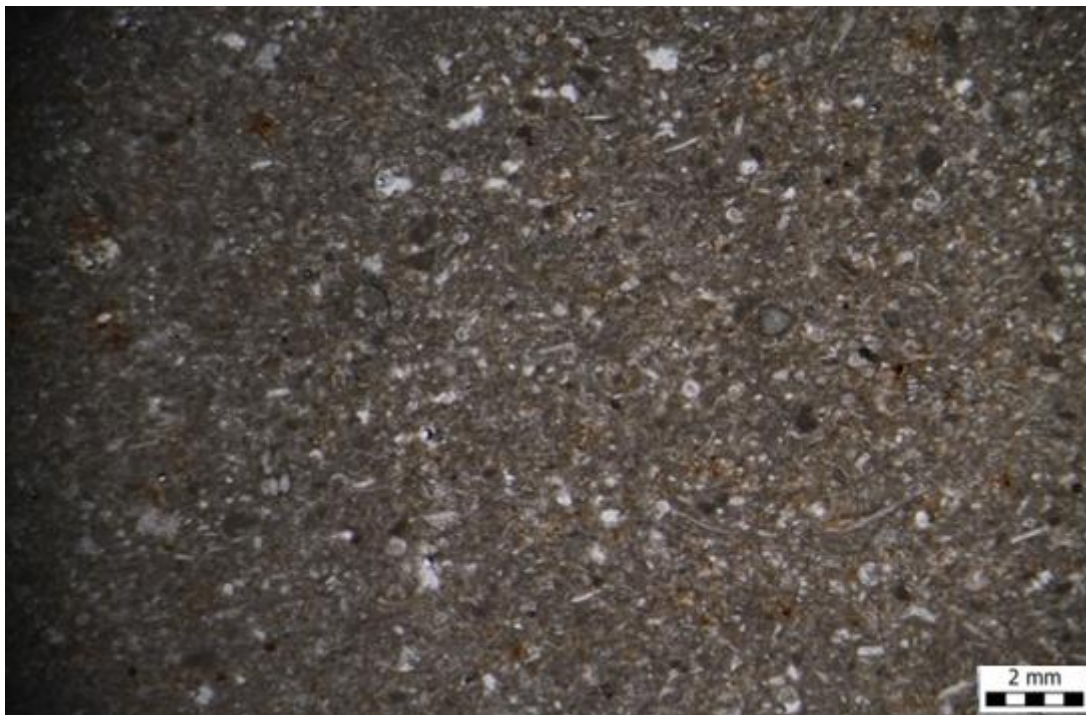
Slika 18. Mikrofotografija uzorka izrađenog iz uzorka A5. Biokalkarenit s presjecima planktonskih foraminifera.
