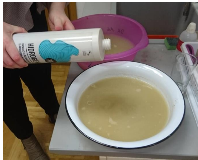
Slika 11. Dodavanje vodikovog peroksida u usitnjeni uzorak sa vodom.
