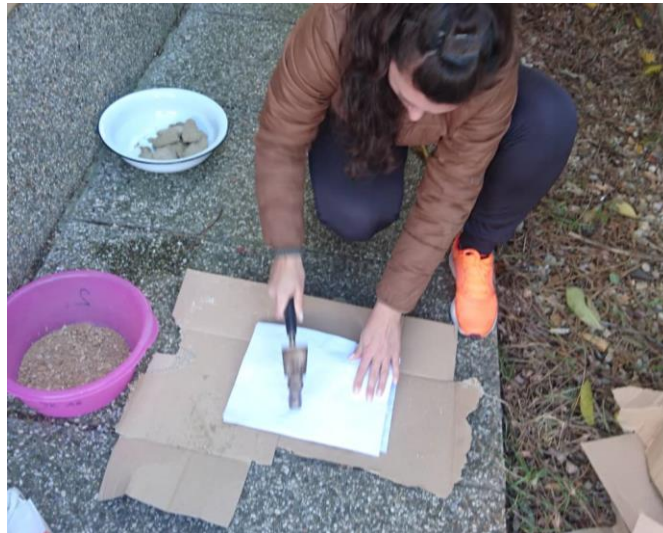
Slika 10. Usitnjavanje uzorka mehaničkim putem.
