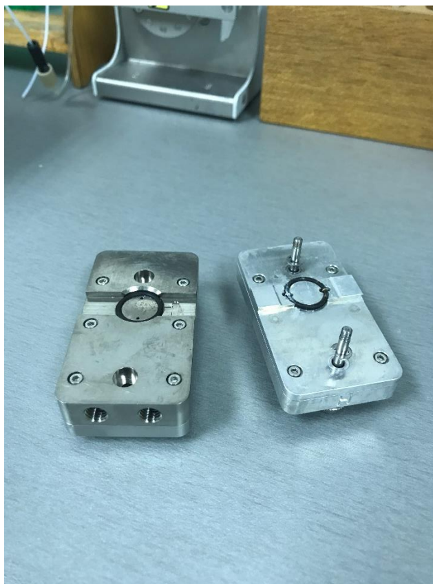
Slika 10. Protočna ćelija, Q-Sense E1, Biolin Scientific, Švedska.
